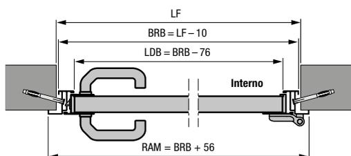
Porta laterale con telaio ad angolo in alluminio, profilo tipo 1 o 2
