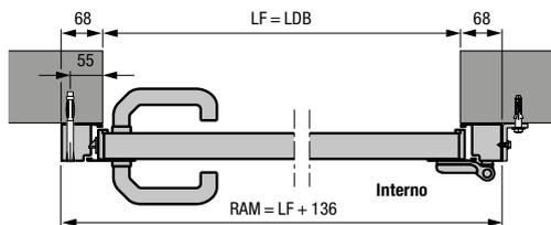
Porta laterale con telaio tubolare in alluminio, profilo tipo 1
