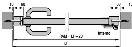
Porta laterale con telaio tubolare in alluminio, profilo tipo 2
