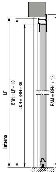
Porta laterale con telaio ad angolo in alluminio, profilo tipo 2
